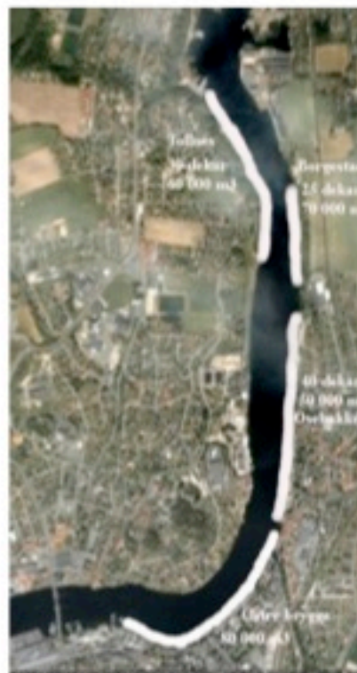
Fig 30 Del av elvestrekningen ved Porsgrunn med utstrekning av steinfyllinger
